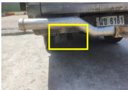
ภาพที่ 2.2-31 รถติดตั้งอุปกรณ์ป้องกันประกายไฟ
